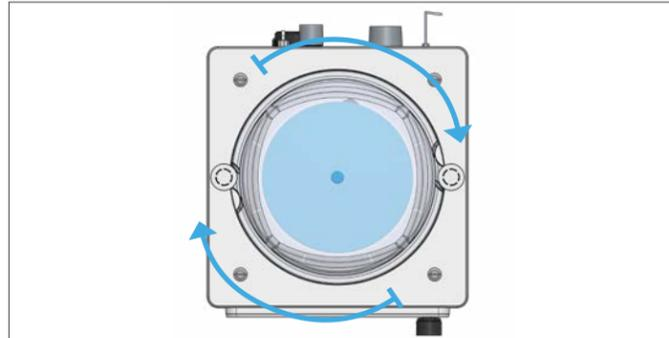
Réassemblez les soufflets et le boîtier des soufflets sur le ventilateur.
